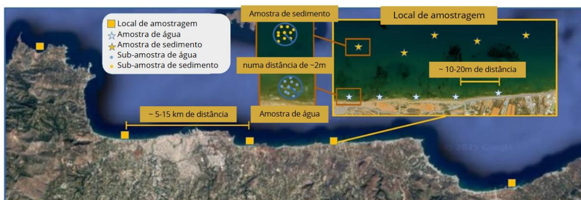
Fig. 2 Exemplo de esquema de amostragem num local de amostragem do Mar do Norte (Ostende, Bélgica)
