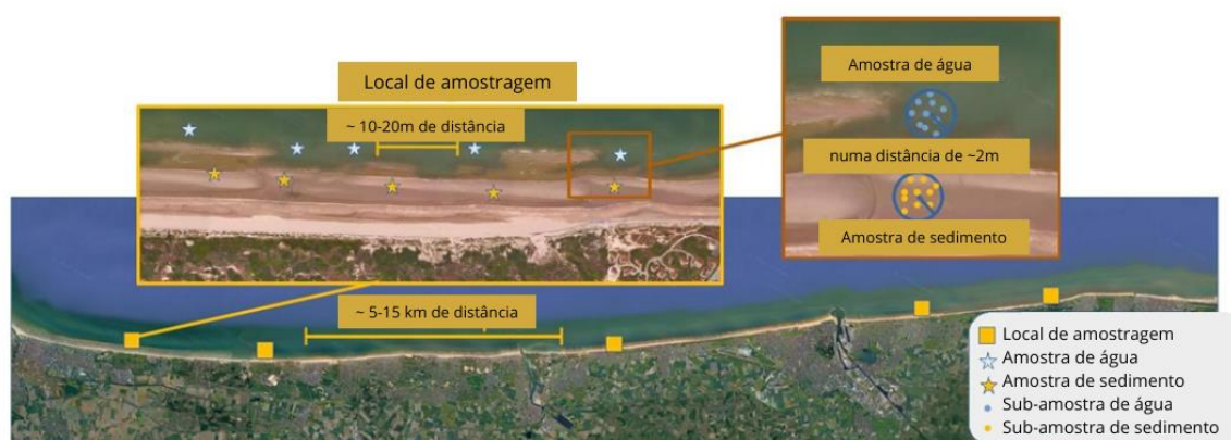
Fig. 2 Exemplo de esquema de amostragem num local de amostragem do Mar do Norte (Ostende, Bélgica)
